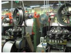
Zusätzlich zum Geflecht werden für die Abschirmung zusätzlich Kupferbänder (Cu/Pet) bei Kupferlitzen (Cu) bzw. Aluminiumbänder (APA) bei verzinnten Litzen(CuSn) oder solchen aus Aluminium (Al) eingesetzt. Auf diese Weise können wir der marktspezifischen Nachfrage nach einer Vielzahl von abgeschirmten Kabeln mit doppelter und dreifacher Abschirmung nachkommen.
