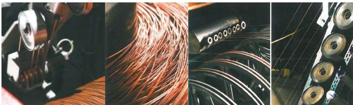
**Descrizione:** si trafilano conduttori in rame rosso da 0,31 mm fino a 3,40 mm di diametro.
