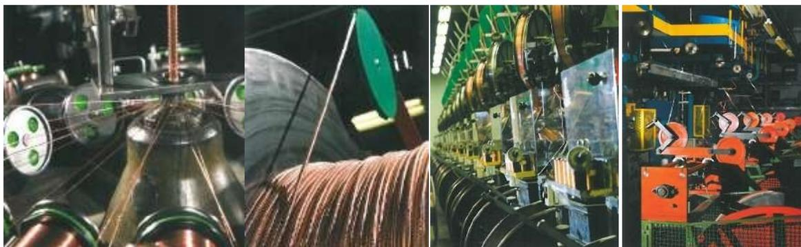
**Descrizione:** viene formata la schermatura dei cavi sull'isolamento primario. Consiste di una treccia realizzata da fili conduttori, con o senza l'interposizione di nastri, anch'essi conduttivi. L'azienda utilizza più di 200 macchine trecciatrici, che garantiscono grande flessibilità e un'elevata capacità produttiva.
