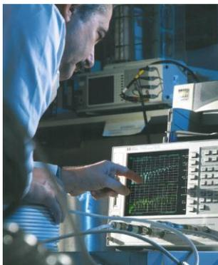
Le Laboratoire d'Italiana Conduuttori Srl effectue de façon systématique une analyse complète et détaillée de tous les câbles finis qui porte sur plusieurs paramètres: dimensions, caractéristiques mécaniques et électriques. Les données suivantes sont contrôlées et enregistrées: fabrication, poids, dimensions physiques, résistance mécanique, résistance électrique des conducteurs, impédance, capacité, pertes par atténuation du signal, pertes de retour structurelle (SRL).
