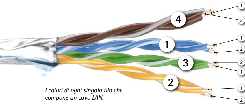
I colori degli 8 fili di un cavo LAN riferiti agli 8 terminali di un connettore RJ-45 (8P8C).
