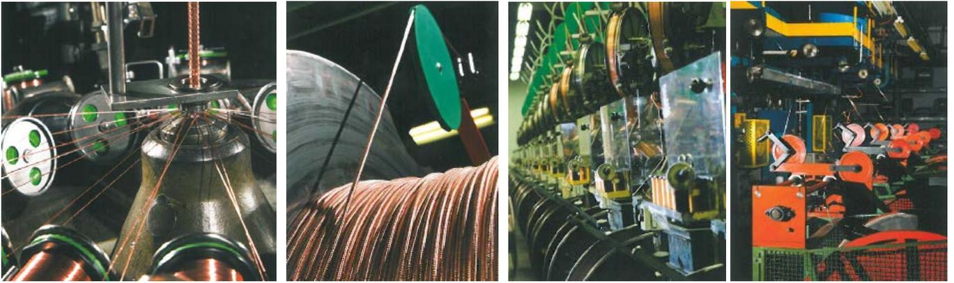
**Beschreibung:** Die Abschirmung der Kabel wird auf der Primärisolierung gebildet. Sie besteht aus einem Geflecht von Leiterdrähten, mit oder ohne Zwischenpositionierung von Bändern, die ebenfalls leitend sind. Im Werk kommen mehr als 200 Flechtmaschinen zum Einsatz, die nicht nur hohe Flexibilität, sondern auch eine ansehnliche Produktionskapazität gewährleisten.
